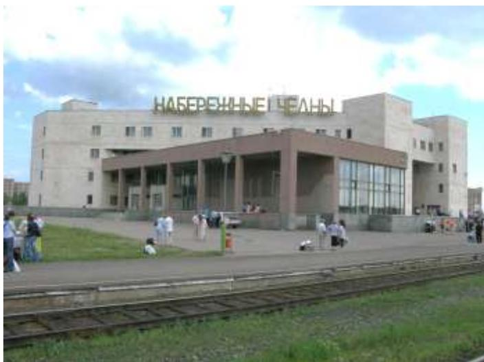
Савинов и В.А. Никольская. Сдан в эксплуатацию в 1990 году. Может одновременно принять до 1100 пассажиров. Общая площадь здания вокзала составляет 8540,8 кв.м. Высота потолка – 6 метров. Здание вокзала Набережные Челны состоит из двух крыльев и представляет собой железобетонную конструкцию и стеклянные витражи. В непосредственной близости от
